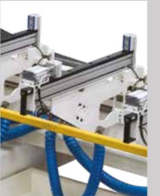
Colocación de las mordazas de forma secuencial o simultánea. Posicionamiento secuencial ou simultâneo dos pneumáticos.
