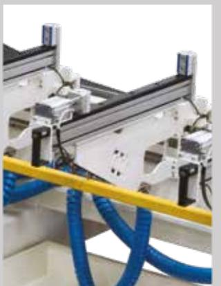
Colocación de las mordazas de forma secuencial o simultánea. Posicionamiento secuencial ou simultâneo dos pneumáticos.
